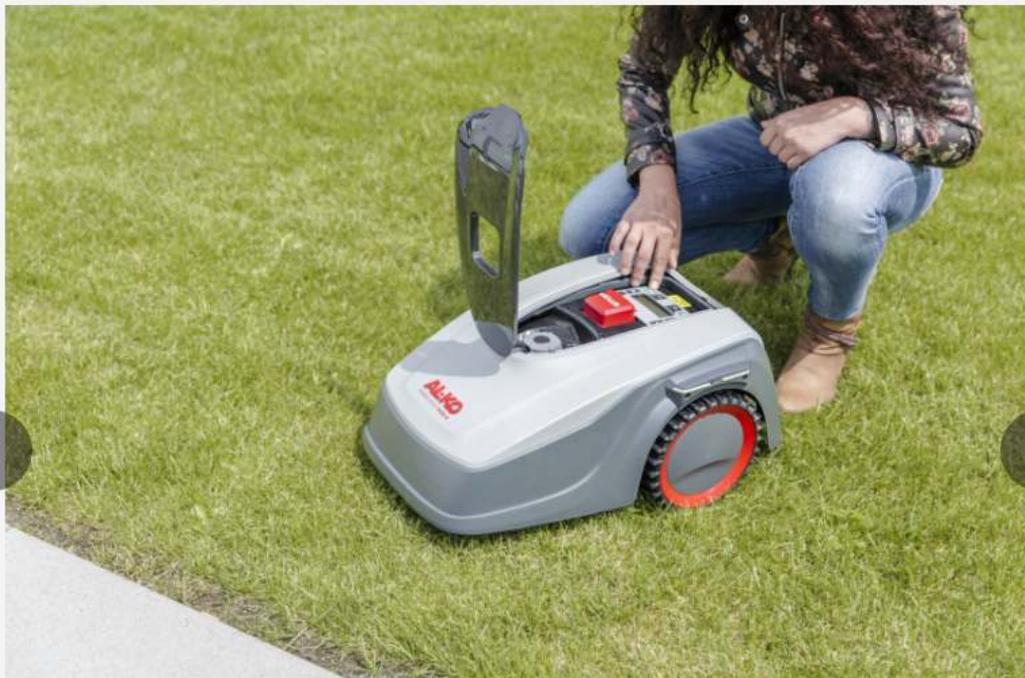
Ein leiser und emissionsfreier Betrieb ist bei diesem Mähroboter durch den 60 dB leisen Elektromotor gegeben, welcher seine Energie von einem 2,5 Ah / 20 V starken und langlebigen Lithium-Ionen-Akku erhält. Fotoquelle: AL-KO
