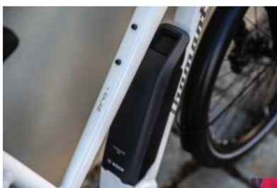
Leicht abnehmbar ist der am Rahmen angebrachte 500-Wh-Akku.
